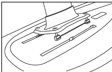
2 Insérez les inserts SCS au dessus des trous de la plaque carbone.
