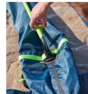
3 - Positionnez le boom sur les pièces supports. La sangle doit se retrouver coincée entre les deux pièces. Vissez ensuite le boom sur le support à l'aide de la vis M6x20 fournie. Répétez l'action de chaque côté
