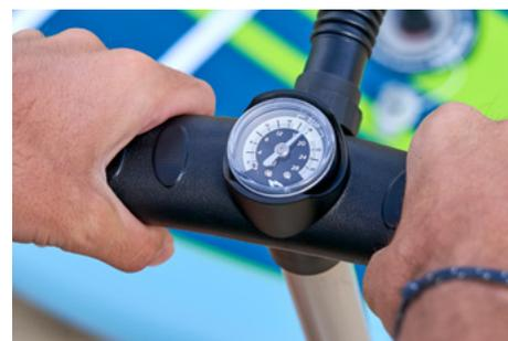
5 Gonflez jusqu'à la pression requise qui doit se situer entre **15 ET 20 PSI**. Il est **normal d'entendre un petit sifflement d'air** au niveau du tuyau de pompe pendant le gonflage. En effet, l'étanchéité du tuyau n'est jamais parfaite, mais les pertes sont insignifiantes. De même, **l'aiguille du manomètre ne commencera à bouger que lorsque la pression interne de la**
