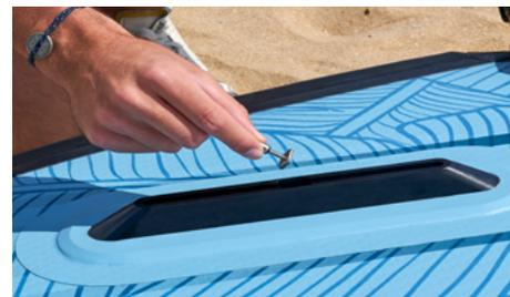
1 Placez l'écrou dans le rail à l'avant du boîtier prévu à cet effet.
