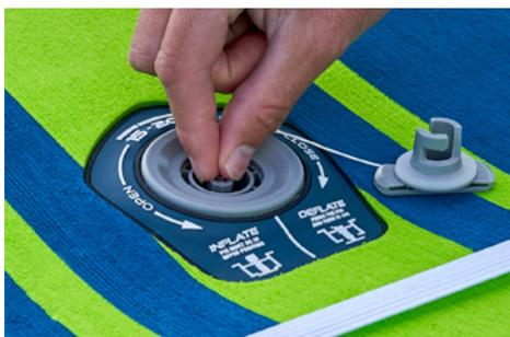
3 Assurez-vous que le bouton de la valve soit en **position haute** pour la phase de gonflage. Il suffit d'appuyer sur le bouton et de le tourner vers la droite ou la gauche. Si vous **ne respectez pas cette recommandation**, la planche se dégonflera au retrait de l'embout de gonflage.
