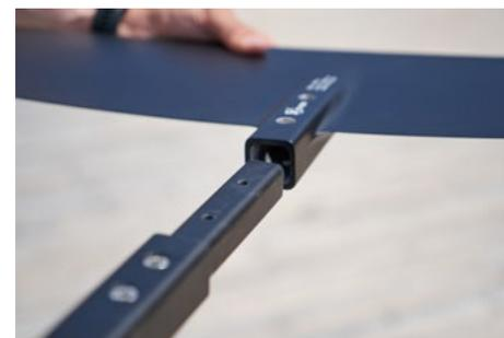
**1** Insérez l'aile avant dans le fuselage. **Pour un meilleur serrage, procéder dans l'ordre suivant.**
