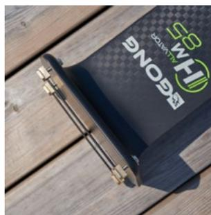
➤ Assemblez les 2 carrés laitons rapides **Smart Connection System (SCS)** avec les 4 vis **M6** appropriées (voir tableau de correspondance ci-dessous) et les rondelles sur la platine de votre mât sans les serrer. Utilisez les **carrés laiton bouchés** avec une **planche gonflable HIPE** afin d'éviter tout risque de dommages causés par des vis trop longues
