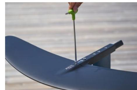
**2** Utilisez d'abord la vis **M6-20 mm C** sous l'aile. Serrez fortement.
