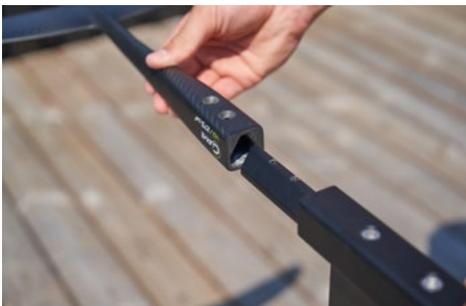
1 Connectez le stab au fuselage.
